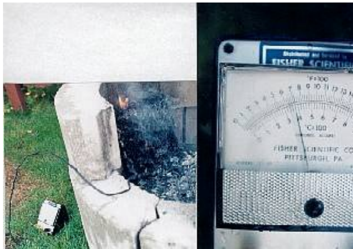
Figure EXP-4 : La combustion dans la masse s'accompagne d'une émission de fumée.
