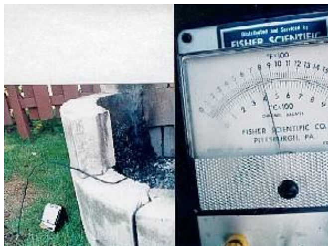
Figure EXP-5 : En l'absence de toute flamme, l'émission de fumée est le seul indice visible qui témoigne de la combustion.
