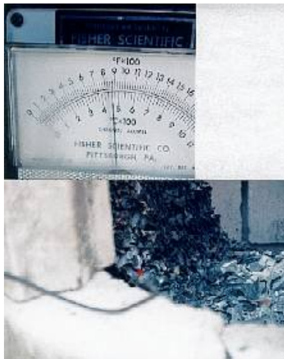
Figure EXP-6 : Une zone incandescente est visible à la base de la masse de cartons.
